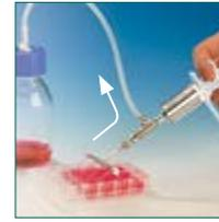
Aspirazione tramite valvola per il modo inverso
